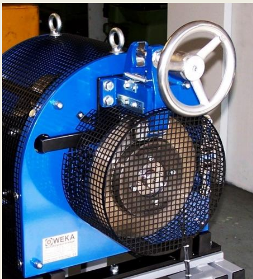
500 Nm Scheibenbremssystem mit Handrad zur Einstellung der Bremskraft
